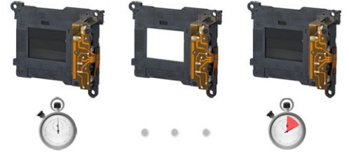
Le temps d'ouverture de l'obturateur contrôle la durée d'exposition
