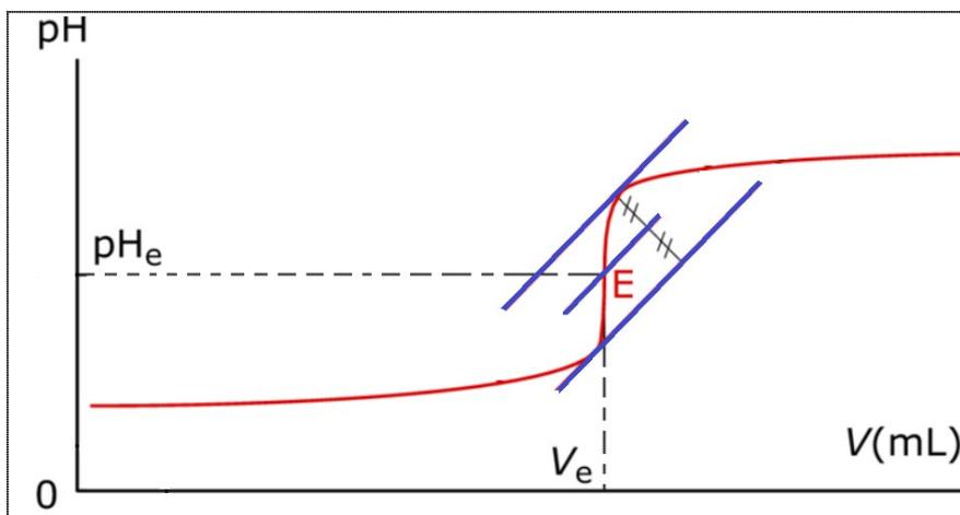
↳ Lors d'un dosage pH-métrique, on trace la courbe  $pH = f(V_{\text{titrante}})$  représentant les variations du pH de la solution dans le bécher, en fonction du volume de la solution titrante versée.
