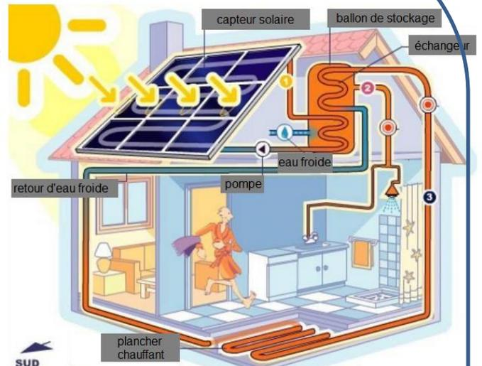
Schéma d'un chauffe-eau solaire (ADEME)
