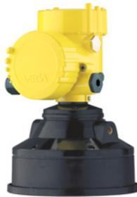
Le VEGASON 63 est un capteur ultrasonique destiné à la mesure de niveau continue de liquide. Le capteur est un transducteur piézoélectrique fonctionnant successivement en émetteur et en récepteur.
