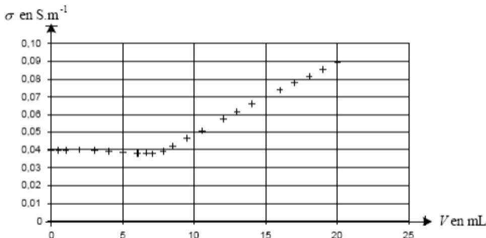
La transformation chimique est modélisée par la réaction entre les ions chlorure et les ions argent en solution aqueuse selon l'équation chimique :  $\text{Cl}^-_{(\text{aq})} + \text{Ag}^+_{(\text{aq})} = \text{AgCl}_{(\text{s})}$
