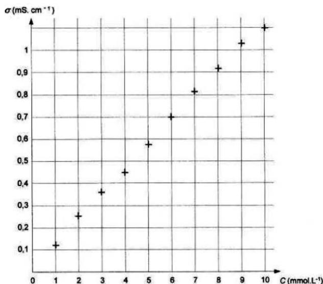
On dilue par un facteur 20 la solution des larmes artificielles. La valeur mesurée de la conductivité de la solution S ainsi obtenue est de 0,880 mS.cm<sup>-1</sup>.
