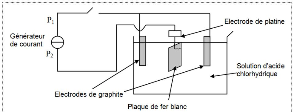
**Remarque :** Ce montage contient deux électrodes de graphite afin que l'attaque du fer blanc puisse se faire des deux côtés de la plaque, en face de chaque électrode de graphite.
