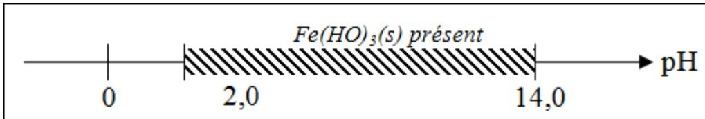
Il faut une valeur du pH pour laquelle  $Zn(OH)_2$  n'est pas encore présent, mais pour laquelle  $Fe(OH)_3$  est présent. Ainsi par décantation, on élimine  $Fe(OH)_3$  tandis que les ions  $Zn^{2+}$  restent en solution.
