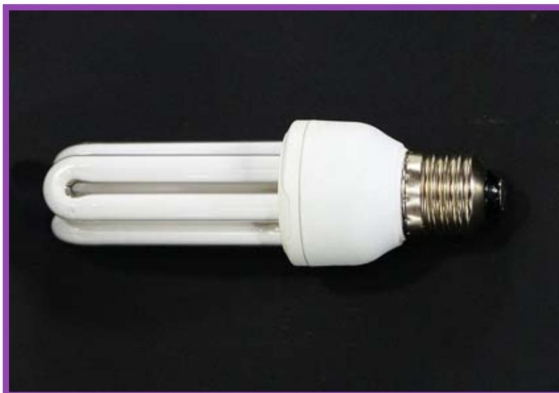
Les lampes fluocompactes, sont des lampes à basse consommation d'énergie, équipées d'un tube fluorescent et d'un ballast électronique. Elles contiennent un gaz principalement constitué de mercure qui, sous l'effet de décharges électriques, produit un rayonnement ultraviolet. Ce rayonnement est absorbé par une poudre déposée sur les parois internes de la lampe puis réémis sous forme de lumière visible.
