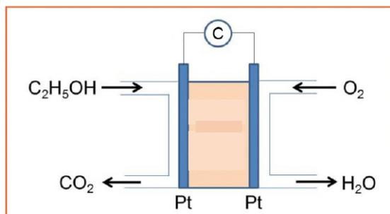
« C » (partie supérieure du schéma) représente le circuit extérieur à la pile.
