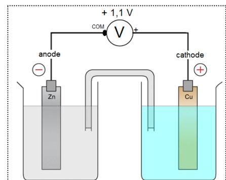
**L'électrode de zinc** constitue le pôle négatif de la pile ; elle *fournit/reçoit* les électrons
