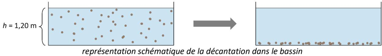
La taille du bassin est directement liée à la durée nécessaire pour qu'une particule ait le temps de se déposer. Le but de cet exercice est de déterminer la durée moyenne au bout de laquelle des particules d'argile atteignent le fond du bassin.
