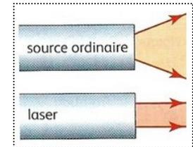
**Le laser émet un faisceau très fin, faiblement divergent, parfaitement rectiligne, et visible sur de grandes distances.**
