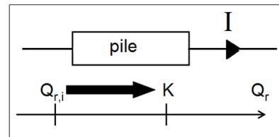
► ► Une pile usée est une pile dont le quotient de réaction s'approche de la constante d'équilibre de la réaction de fonctionnement de la pile.
