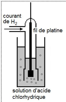
↳ La demi-pile de gauche est particulière : elle est constituée d'un fil de platine (pôle - de la pile) trempant dans une solution d'acide chlorhydrique; un courant de dihydrogène  $\text{H}_2$  arrive au contact avec le fil de platine. Cette demi-pile mettant en jeu le couple  $\text{H}_3\text{O}^+/\text{H}_2$  est appelée « **électrode standard à hydrogène** » et notée **E.S.H.**
