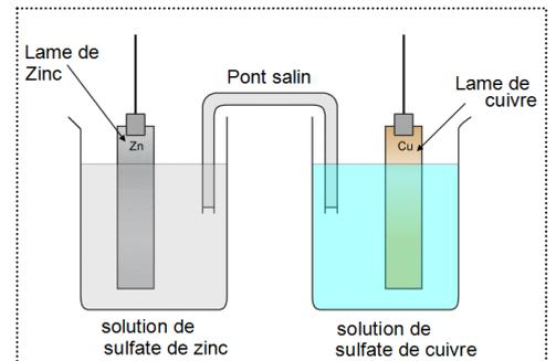
Les deux demi-piles sont reliées par un pont salin rempli d'une solution de chlorure de potassium (K<sup>+</sup>, Cl<sup>-</sup>).
