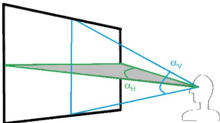
Il existe un angle de champ horizontal  $\alpha_H$  et un angle de champ vertical  $\alpha_V$
